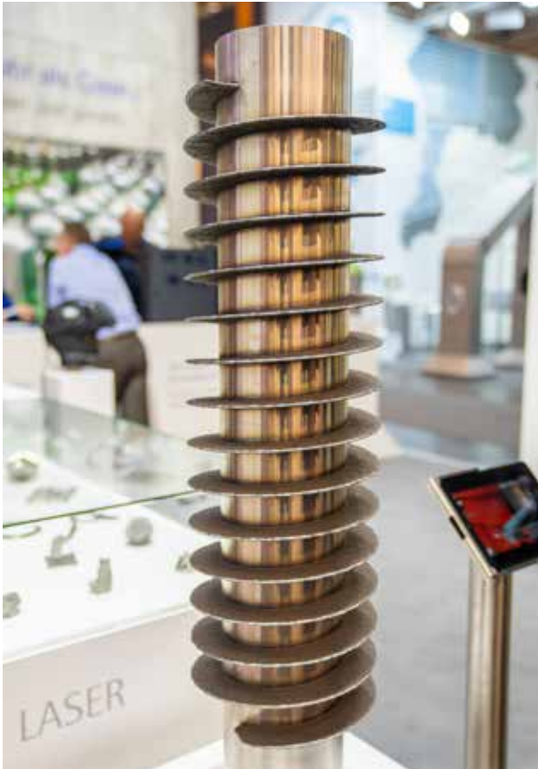
DED-LB gedruckte Förderschnecke
